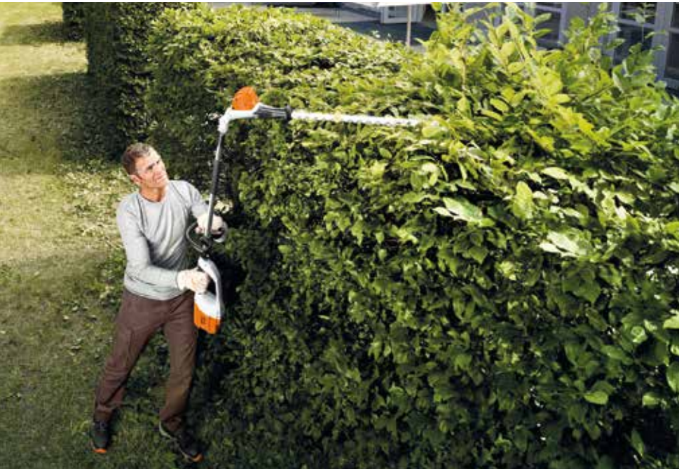
Geräte mit einem abwinkelbaren Messerbalken ermöglichen die Pflege hoher Hecken bequem vom Boden aus. Fotos: STIHL
