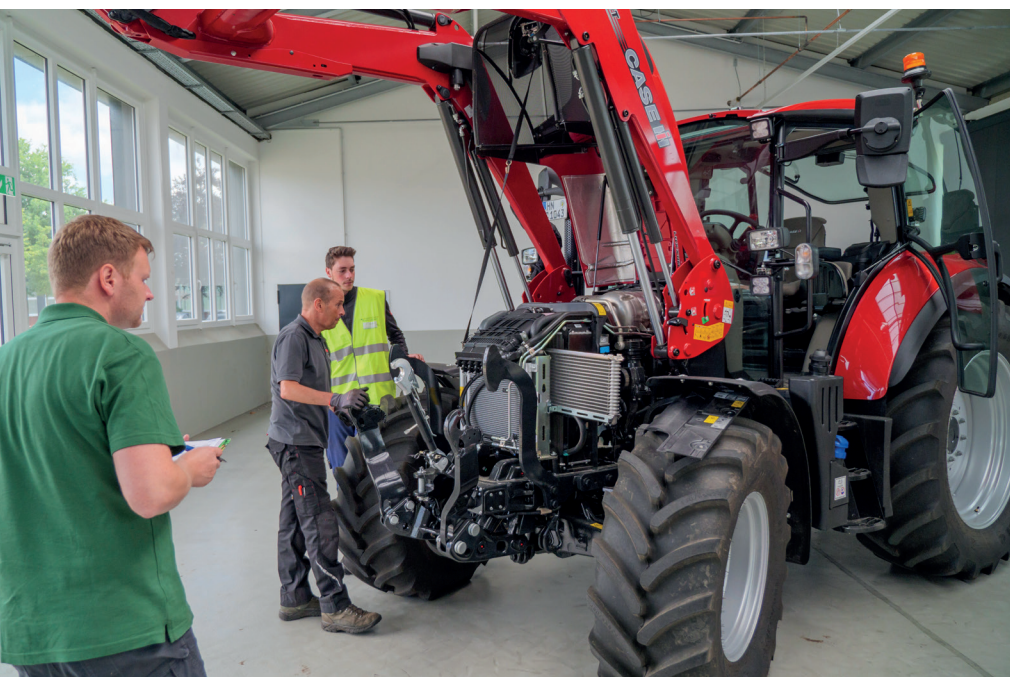
Die Motorhaube des Case IH Luxxum 100 öffnet schön weit, so können einige Kühler zum Säubern herausgezogen werden.
